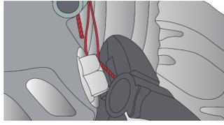
Stisnite ručke kliješta da oslobodite kromirani klizač za zaključavanje, a zatim pomoću integriranog rezača žice odrežite žice na željenu duljinu.
