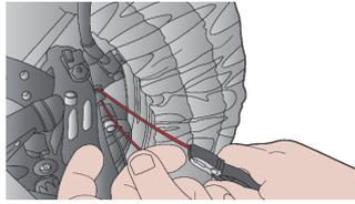
Upotrijebite kliješta za uvijanje sigurnosne žice da uhvatite dvije žice na odgovarajućoj udaljenosti od spojnice. Duljina žica između kliješta i spojnice bit će objašnjena u sljedećem koraku.
