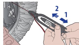
Suelte los mangos de los alicates y tire del mango cromado de la base de los alicates para girar los alicates y retorcer el alambre en el sentido de las agujas del reloj.
