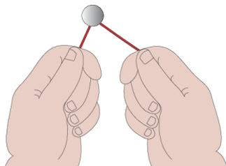
Pase el cable de seguridad a través de su(s) sujetador(es) de la manera apropiada. Ahora tendrá dos extremos del cable listos para ser enroscados.
