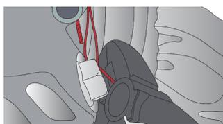
Apriete los mangos de las pinzas para liberar el deslizador de bloqueo cromado y, a continuación, utilice el cortaalambres integrado para recortar los alambres a la medida.
