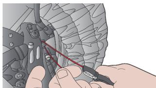
Utilice los alicates de seguridad para retorcer los dos cables a una distancia adecuada del cierre. La longitud de los cables entre los alicates y el cierre se retorcerá en el siguiente paso.
