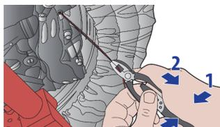
Deslice el manguito de bloqueo central cromado para bloquear los mangos de las pinzas, sujetando los extremos del cable.
