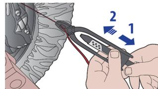
Pustite ručke kliješta i povucite hromiranu ručku na dnu kliješta kako biste rotirali kliješta i uvrnuli žicu u smjeru kazaljke na satu.
