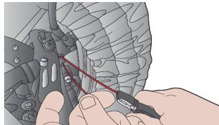
Използвайте клемщите за усукване на предпазен проводник, за да хванете двата проводника на подходящо разстояние от закопчалката.
